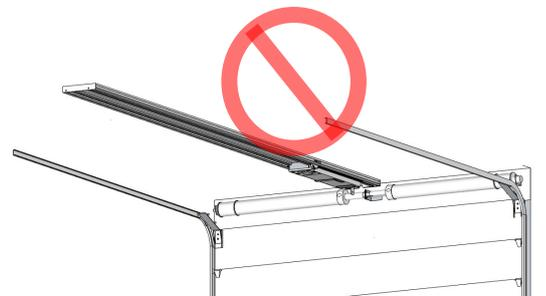
3. Halten Sie einen Mindestabstand von 700 mm hinter der Schiene ein! Dies liegt daran, dass für eine ordnungsgemäße Wartung des Systems die Motoreinheit von der Schiene entfernt werden muss. Dies kann nur durch Entfernen der hinteren Abdeckung und Herausschieben der 700 mm langen Motoreinheit aus der Schiene erfolgen.
